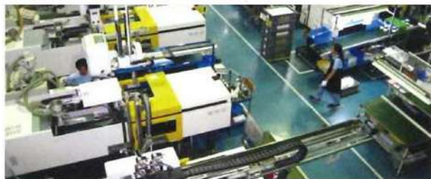
▲ 主力製造設備である射出成形機が並ぶ工場
